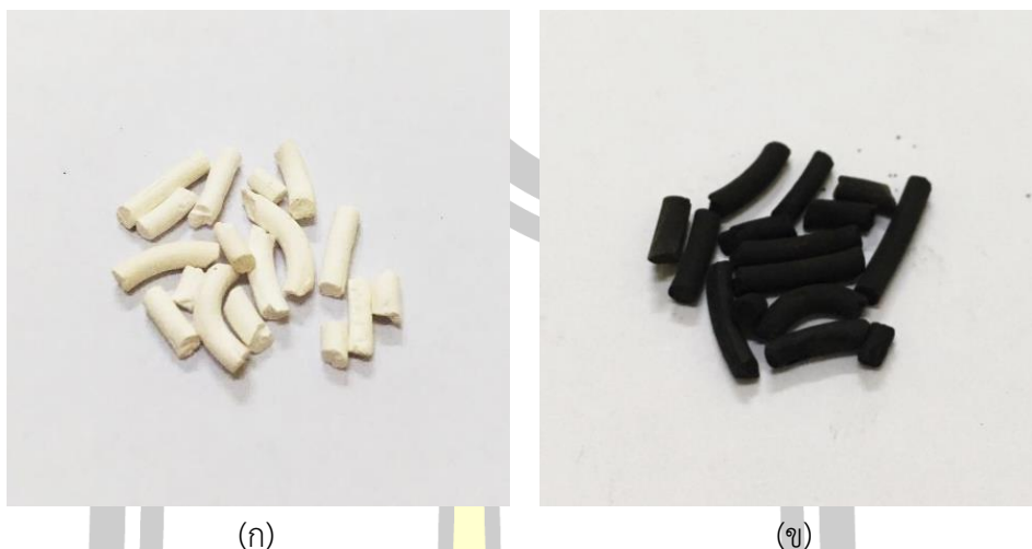
ภาพประกอบ 4.26 ตัวเร่งปฏิกิริยา ZSM-5 (ก) ก่อนและ (ข) หลังการทดลอง
