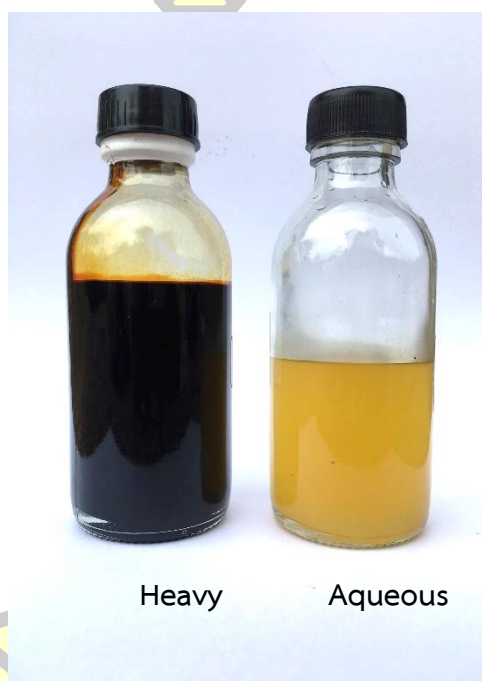
ภาพประกอบ 4.2 ไบโอเออยล์เฟสต่าง ๆ ที่ผลิตได้จากกระบวนการไพโรไลซิสโดยไม่ใช้ตัวเร่งปฏิกิริยา
